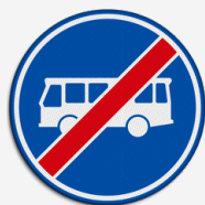
Bord F14 Einde busbaan of - strook.
